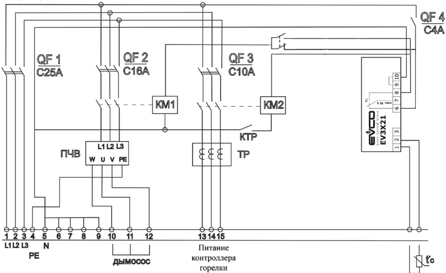
**Рис. 4 Принципиальная электрическая схема УПУ режим ГОРЕЛКА**
