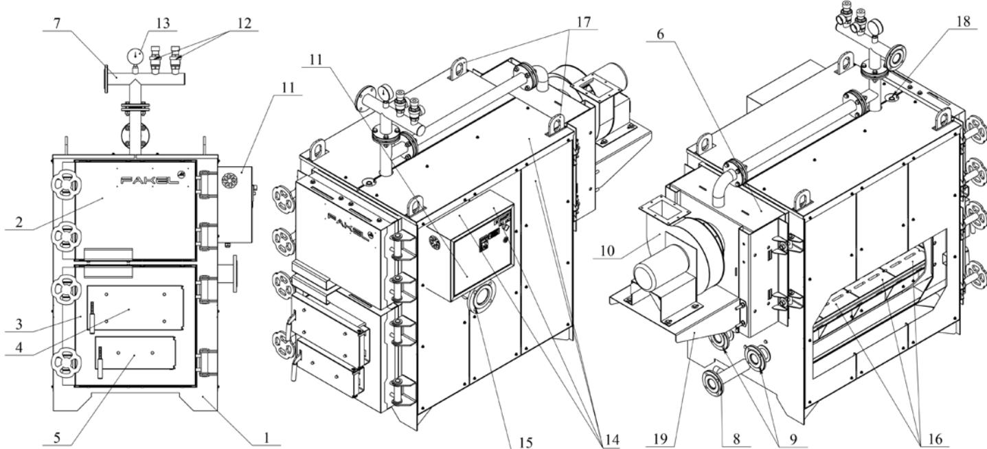
**Рис. 1 Устройство котла FAKEL-M**
