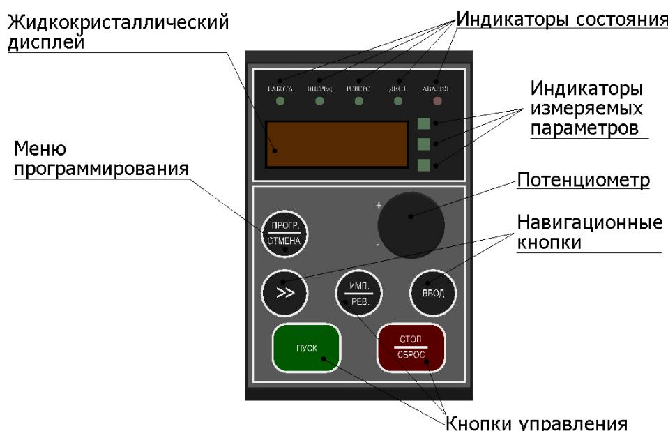
**Рис. 6 Функции кнопок преобразования частоты.**
