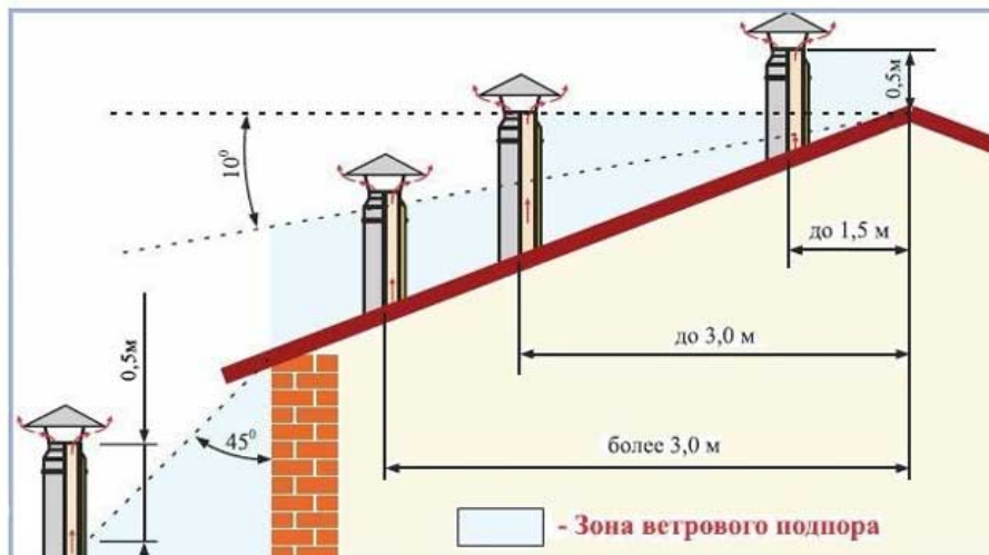
Рис. 6 Высота дымохода.
