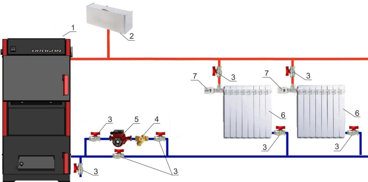
**Рис. 6 Схема подключения котла к открытой системе с принудительной циркуляцией теплоносителя<sup>1</sup>**
