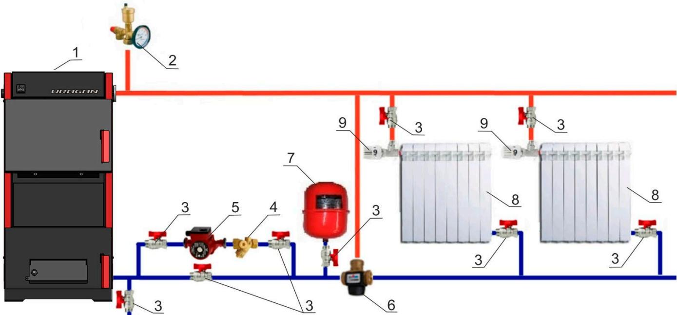
**Рис. 5 Схема подключения котла к закрытой системе с принудительной циркуляцией теплоносителя с термостатическим смесительным клапаном<sup>1</sup>**
