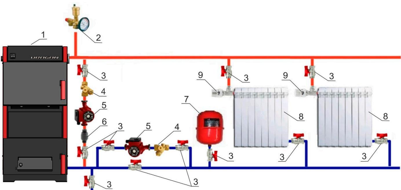
**Рис. 4 Схема подключения котла к закрытой системе с принудительной циркуляцией теплоносителя с рециркуляционным насосом<sup>1</sup>**
