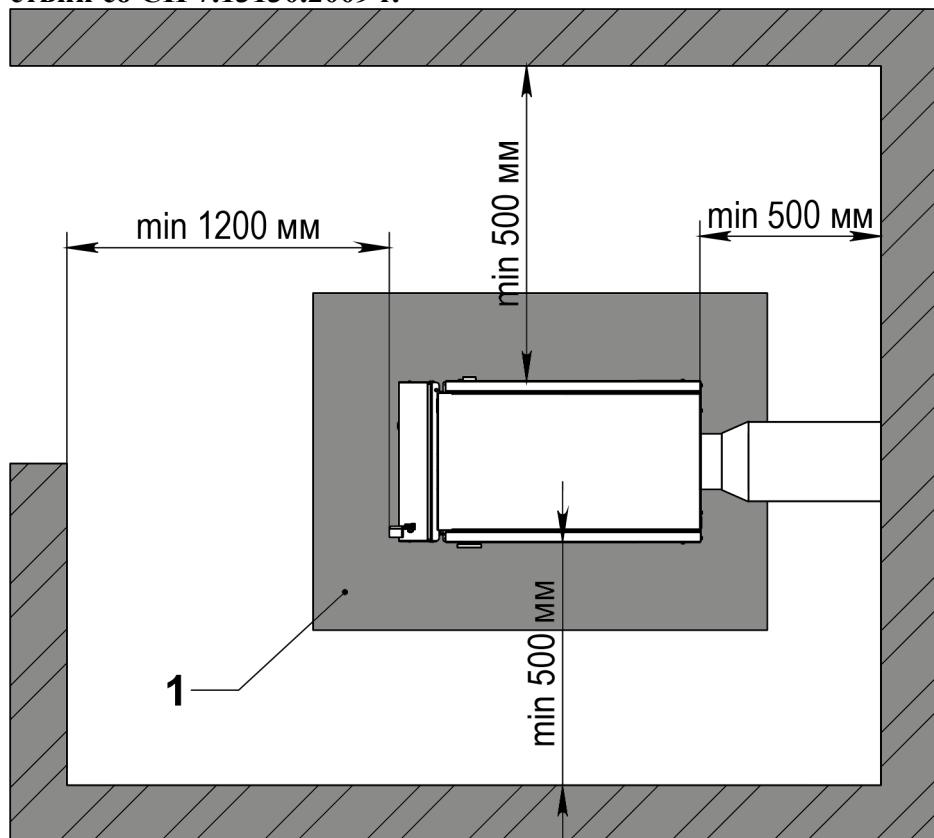
Расстояния безопасности от котла до возгораемых материалов должны быть не менее 500 мм, между верхом котла и потолком 1200 мм, а до противоположной стены 1250 мм.
