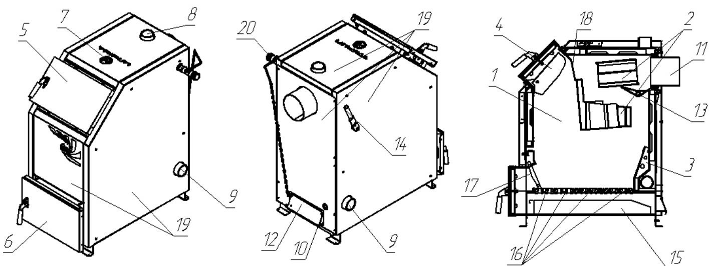
**Рис. 4 Устройство котла TAIFUN 30кВт**
