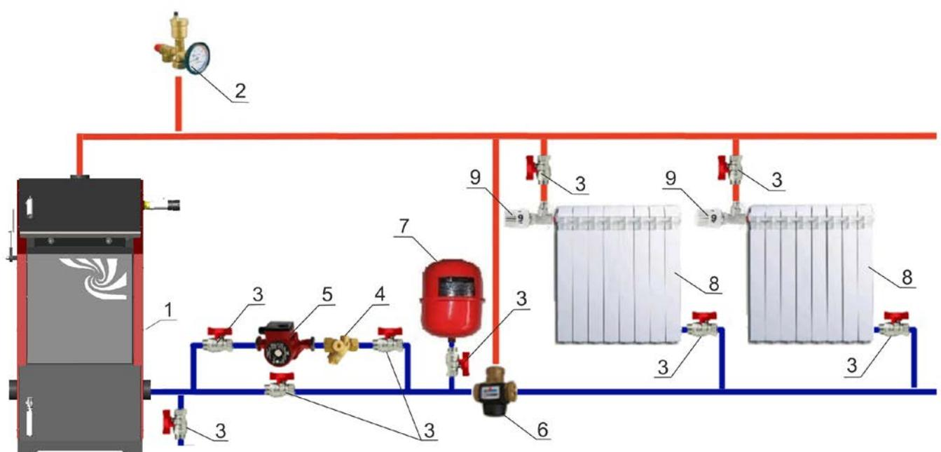
**Рис. 8 Схема подключения котла к закрытой системе с принудительной циркуляцией теплоносителя с терmostатическим смесительным клапаном**
