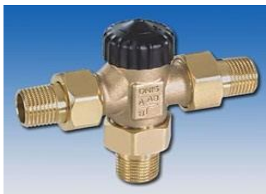
Рис.7 Трехходовой разделительный клапан Heimeier ДУ 25, 1"НР, Kvs=4.6
